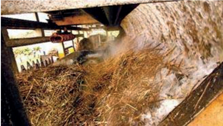
Figura 4 - Lavagem tradicional da cana com água
